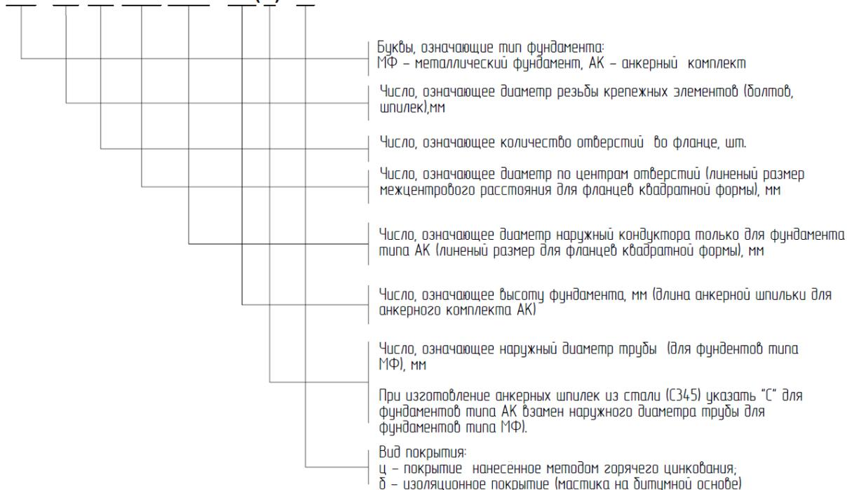
Рисунок 5.3 – Условные обозначения металлических фундаментов
