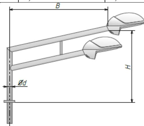
Рисунок Д.6 - кронштейн угловой с двумя посадочными местами под приборы освещения, однонаправленный – КУ1-2
