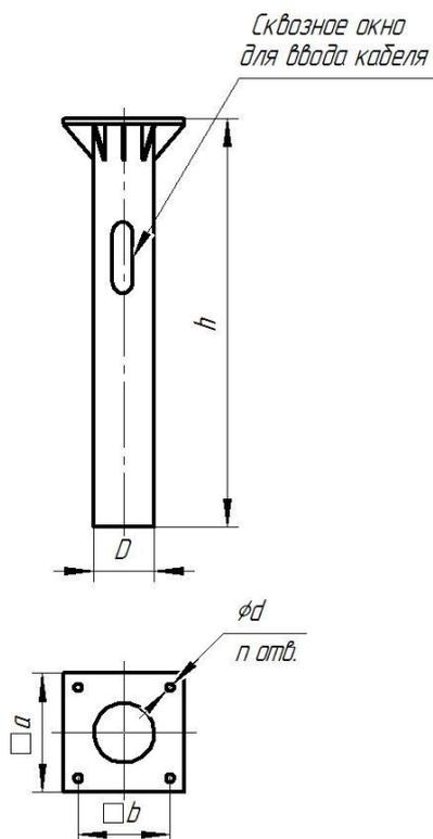
Рисунок В.3 Основные параметры металлических фундаментов к опорам НГ-Ф
