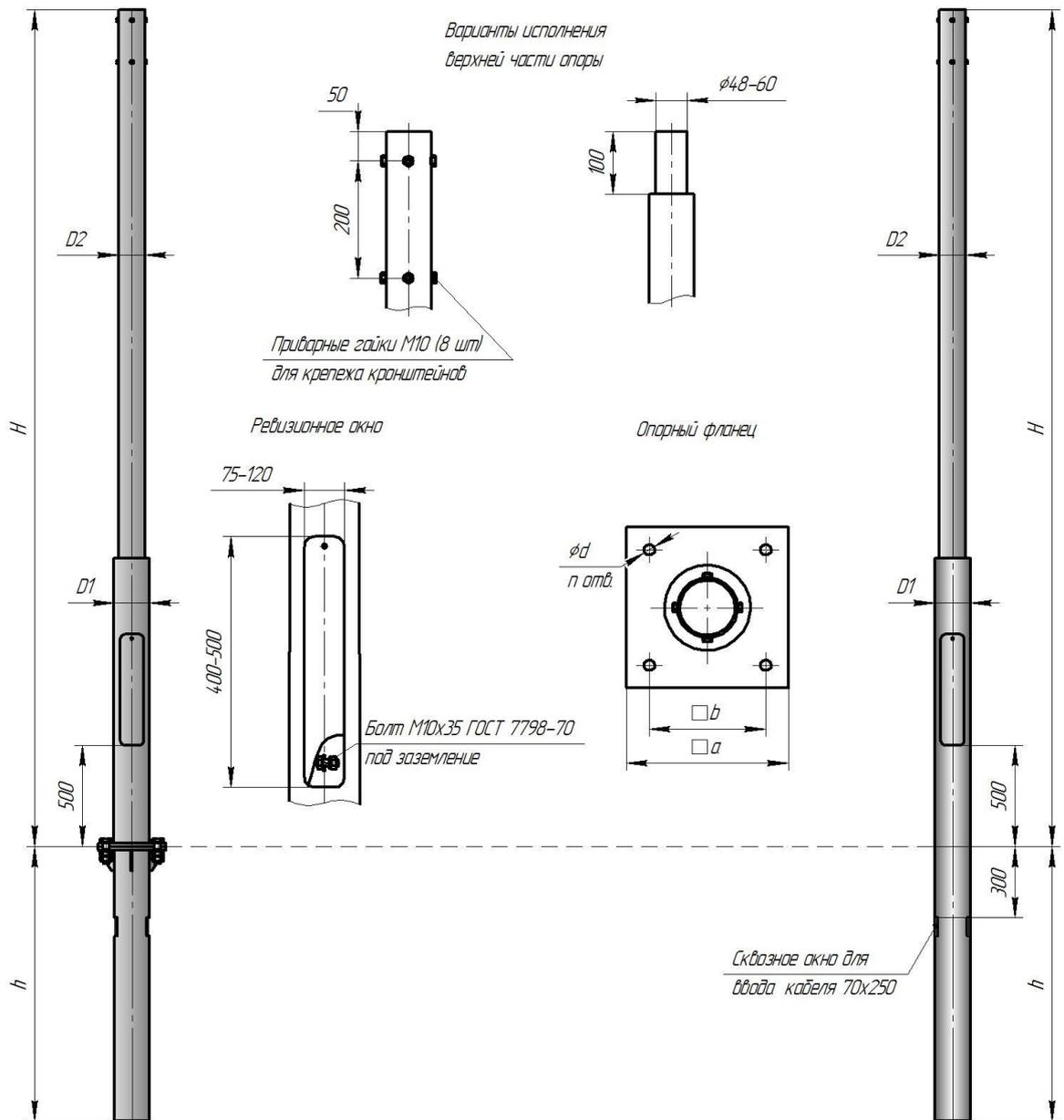
Рисунок В.6.1 - Опора НТ-Ф
