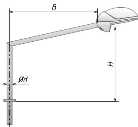
Рисунок Д.5 - кронштейн угловой с одним посадочным местом под приборы освещения, однонаправленный – КУ1
