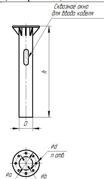
Рисунок В.13 Основные параметры металлических фундаментов к опорам КСТ-Ф
