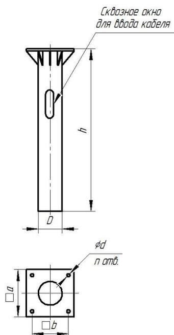
Рисунок В.1 Основные параметры металлических фундаментов к опорам НК-Ф
