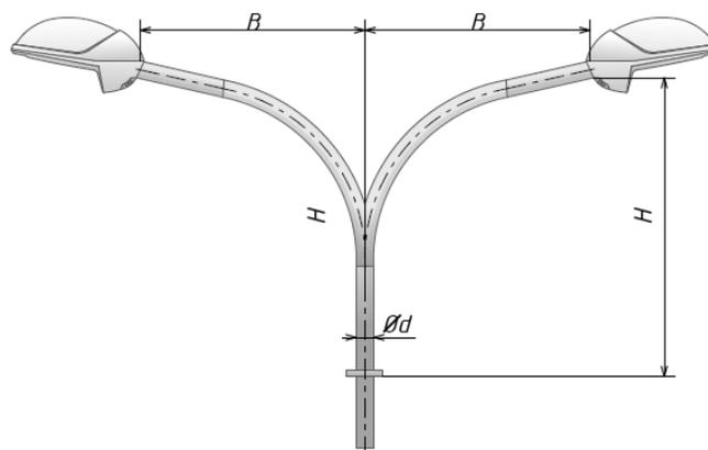
Рисунок Д.3 - кронштейн радиусный с двумя посадочными местами под приборы освещения, разнонаправленный – КР2
