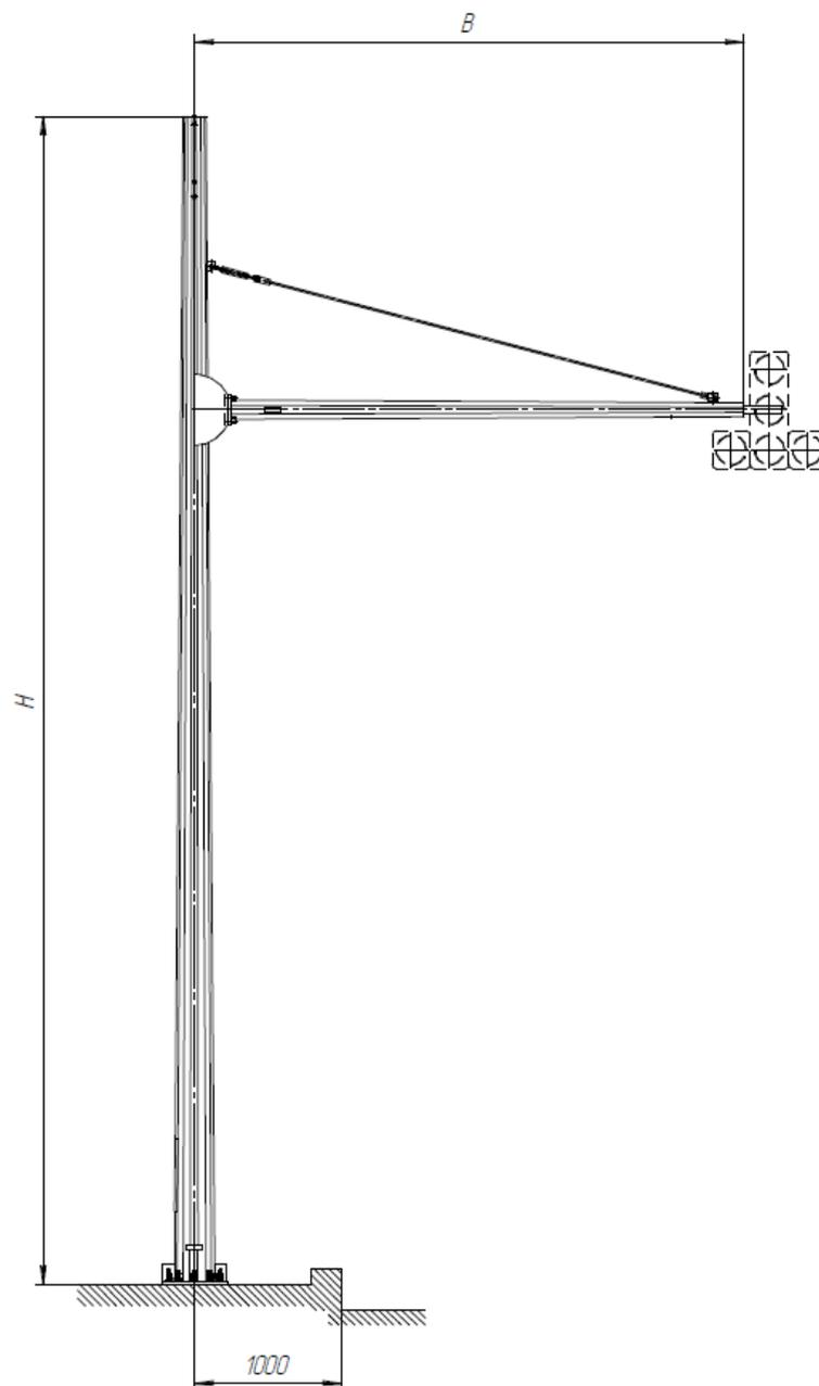
Рисунок В.16 – Общий вид светофорной опоры СВГ-Ф
