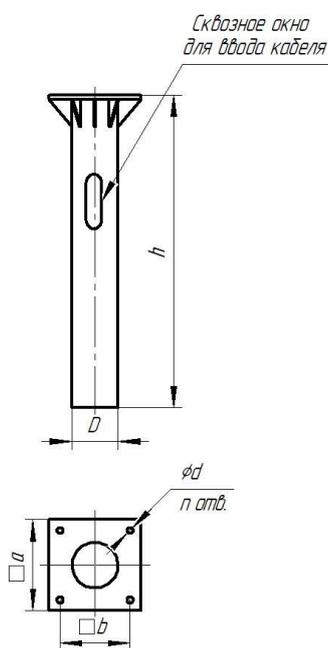
Рисунок В.5 Основные параметры металлических фундаментов к опорам НТ-Ф
