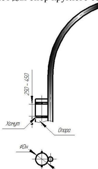
Рисунок Г.4 - установочное место приставного кронштейна типа «П»
