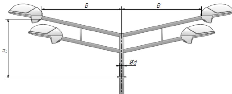
Рисунок Д.8 - кронштейн угловой с четырьмя посадочными местами под приборы освещения, двунаправленный – КУ2-2
