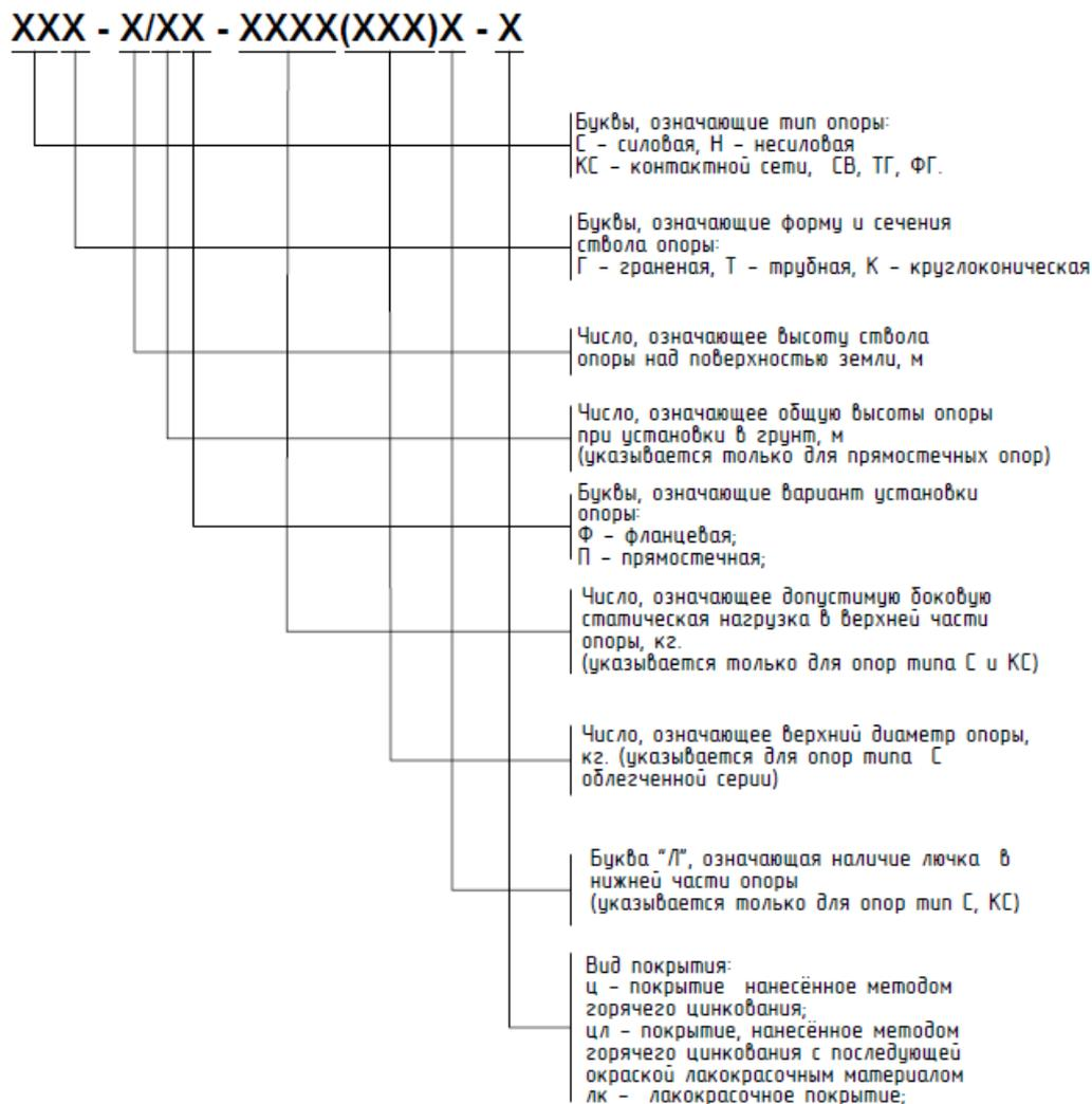
Рисунок 5.1 – Условные обозначения опор освещения
