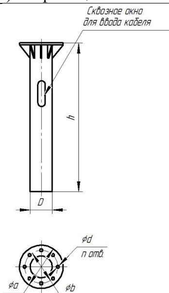
Рисунок В.11 Основные параметры металлических фундаментов к опорам КСГ-Ф
