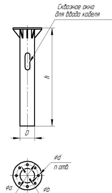
Рисунок В.9 Основные параметры металлических фундаментов к опорам СТ-Ф
