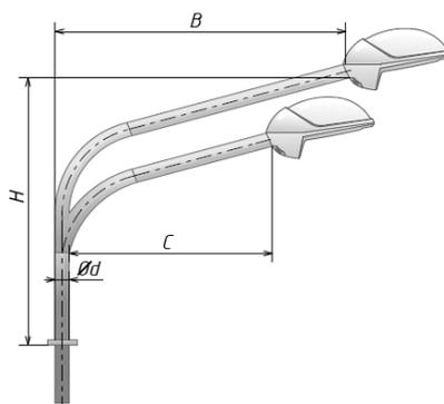
Рисунок Д.2 - кронштейн радиусный с двумя посадочными местами под приборы освещения, однонаправленный – КР1-2
