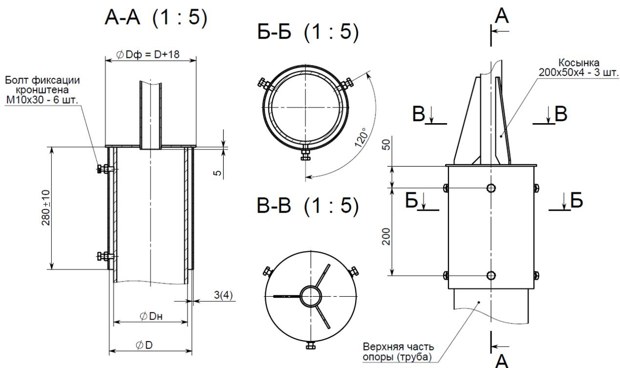
Рисунок Г.2 - установочное место кронштейнов с обечайками типа «О»
