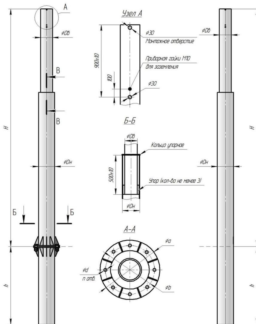
Рисунок В.10.1 – Опора СТ-Ф
