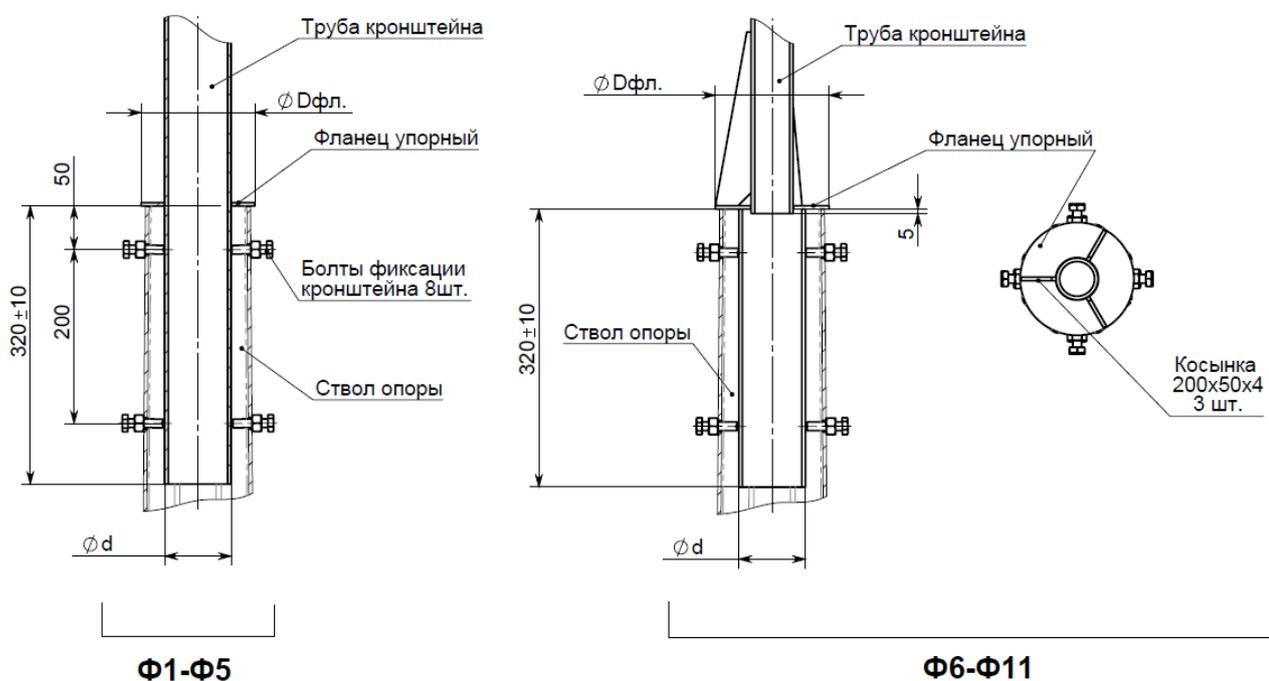
Рисунок Г.3 - установочное место кронштейнов с фланцами типа «Ф»
