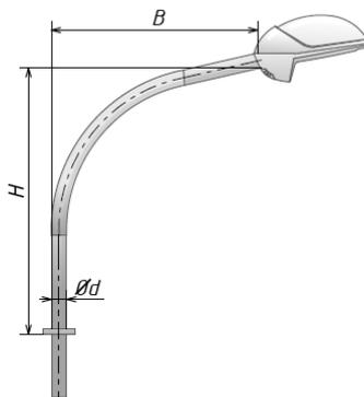
Рисунок Д.1- кронштейн радиусный с одним посадочным местом под приборы освещения – КР1
