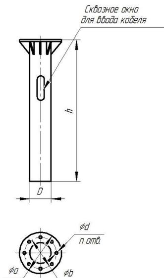
Рисунок В.7 Основные параметры металлических фундаментов к опорам СГ-Ф
