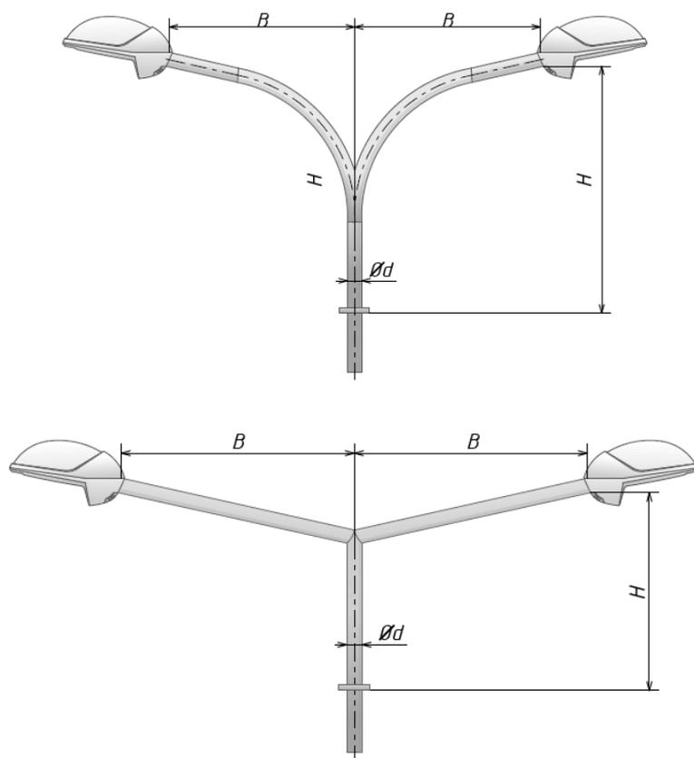
Рисунок Д.7 - кронштейн угловой с двумя посадочными местами под приборы освещения, двунаправленный – КУ2
