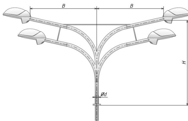
Рисунок Д.4 - кронштейн радиусный с четырьмя посадочными местами
