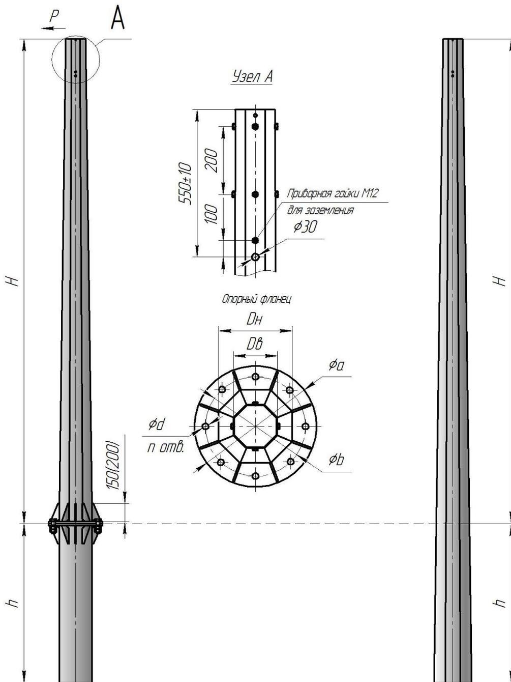
Рисунок В.12.1 – Опора КСГ-Ф, ТФГ
