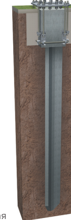
Фундамент свайный железобетонный
