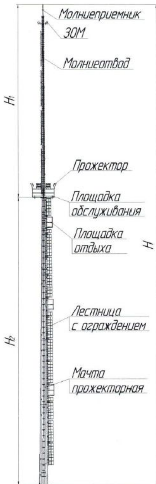
Рисунок В.7 – Мачта МС комбинированная
