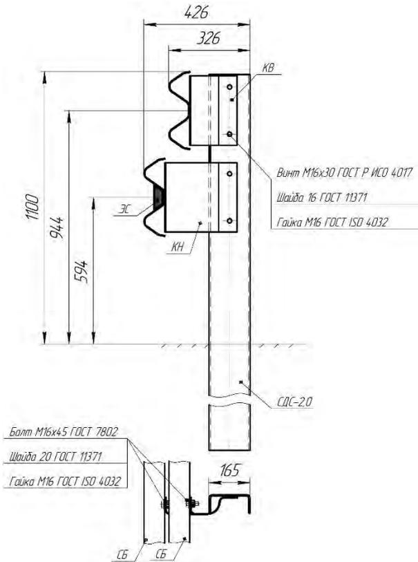
Рисунок В.25 – Ограждение дорожное высотой 1,1 м,
