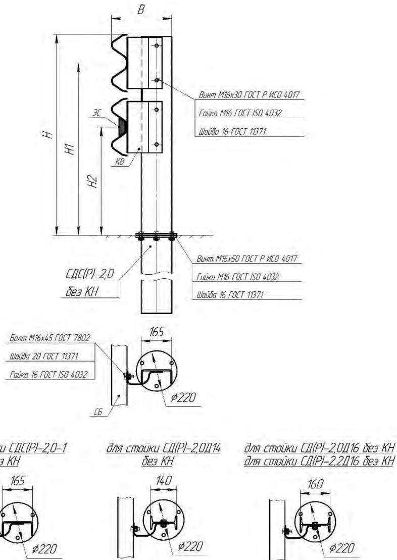
Рисунок Г.3 – Дорожное разборное ограждение 21ДО/350÷550 без КН
