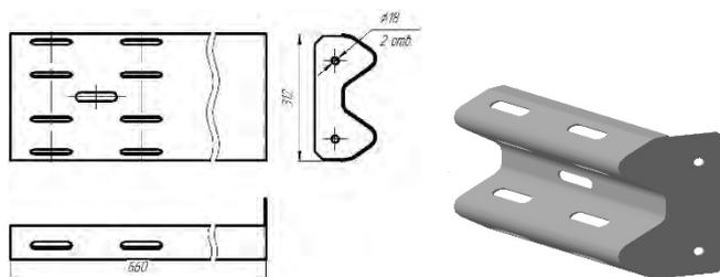
Рисунок Е.12 – Основные параметры элемента концевого ЭК-3
