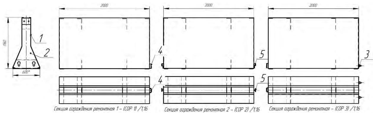
Рисунок Д.8 – Ремонтные секции ограждения 21ДД-1,16
