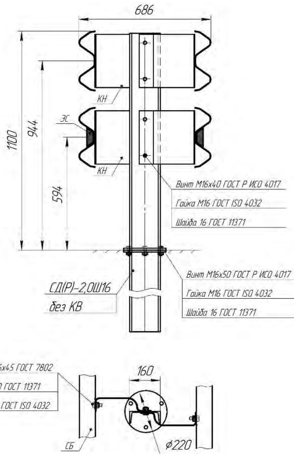
Рисунок Г.7 – Дорожное разборное ограждение 21ДД/350-1,1х3,0Ш16-1,01(1,55)
