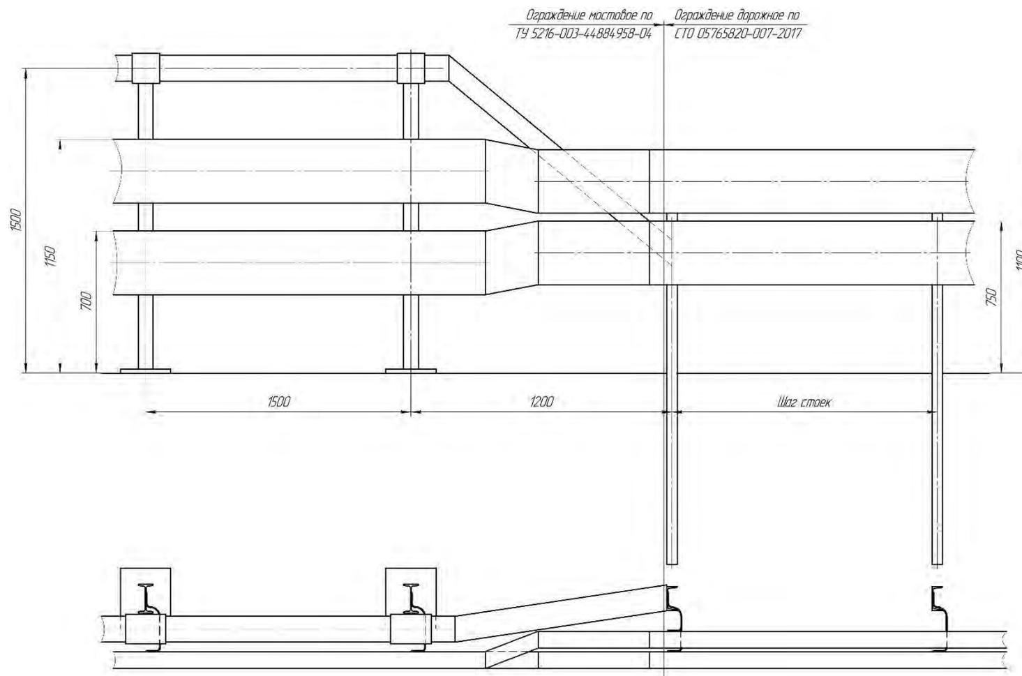
Рисунок Ж.11 – Сопряжение мостового ограждения по [11] (h-1500)
