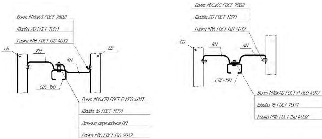
Рисунок Б.2 – Варианты соединения консоли-амортизатора со стойкой СДС-150
