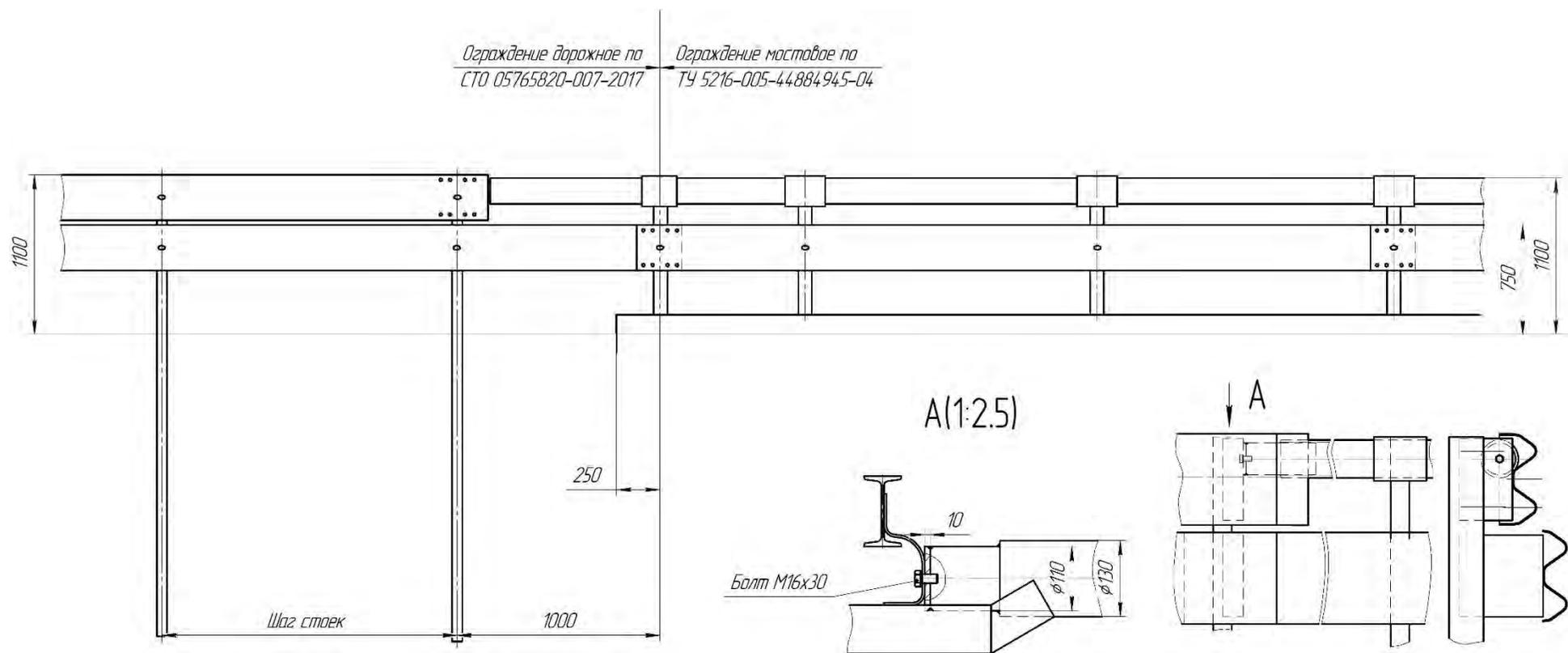
Рисунок Ж.9 – Сопряжение дорожного ограждения по [16]
