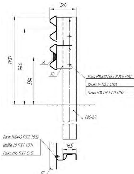
Рисунок В.26 – Ограждение дорожное высотой 1,1 м,
