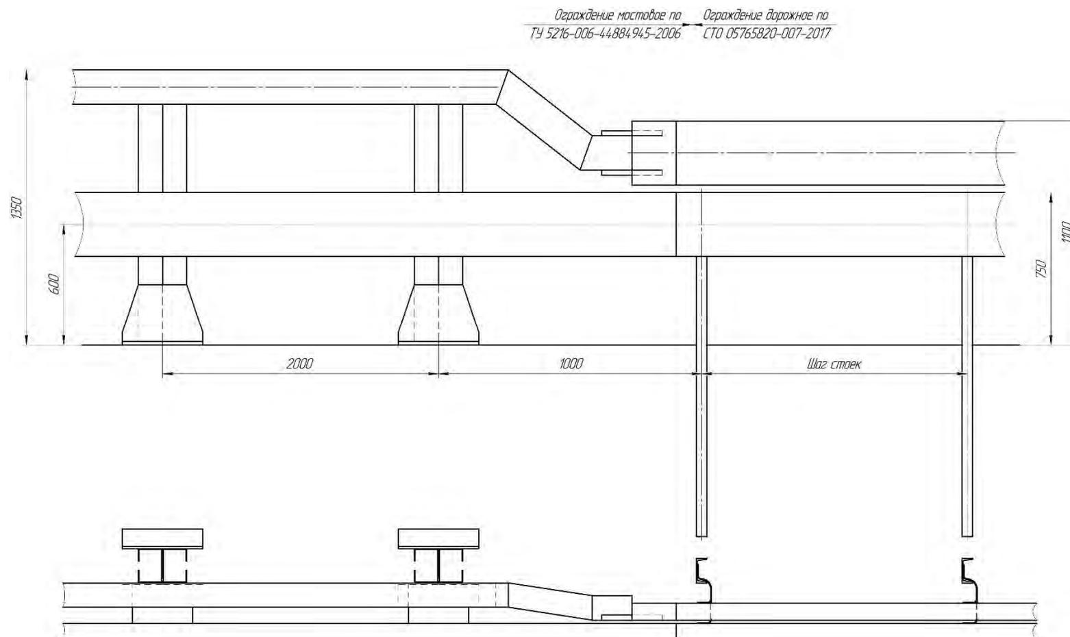
Рисунок Ж.7 – Сопряжение мостового ограждения по [15] (h-1350)
