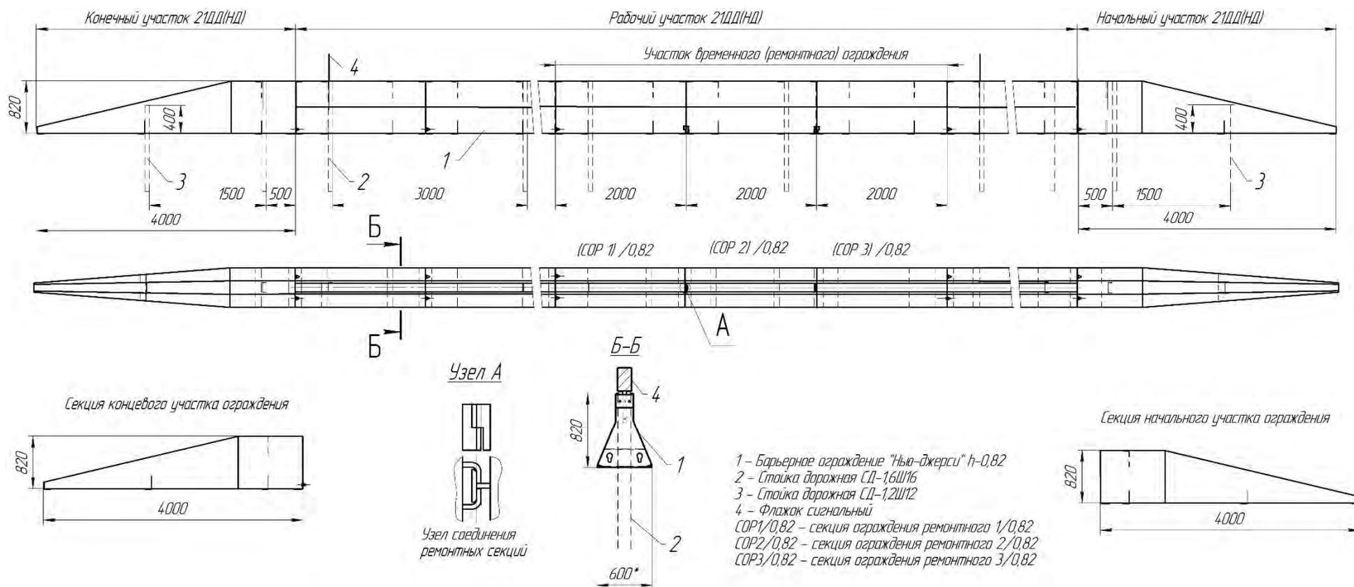
Рисунок Д.5 – Схема сборки дорожного ограждения 21ДД/190÷300-0,82(НД) с участком временного ограждения
