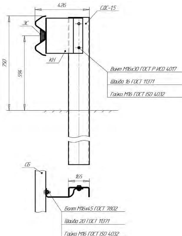
Рисунок В.6 – Ограждение дорожное высотой 0,75 м,
