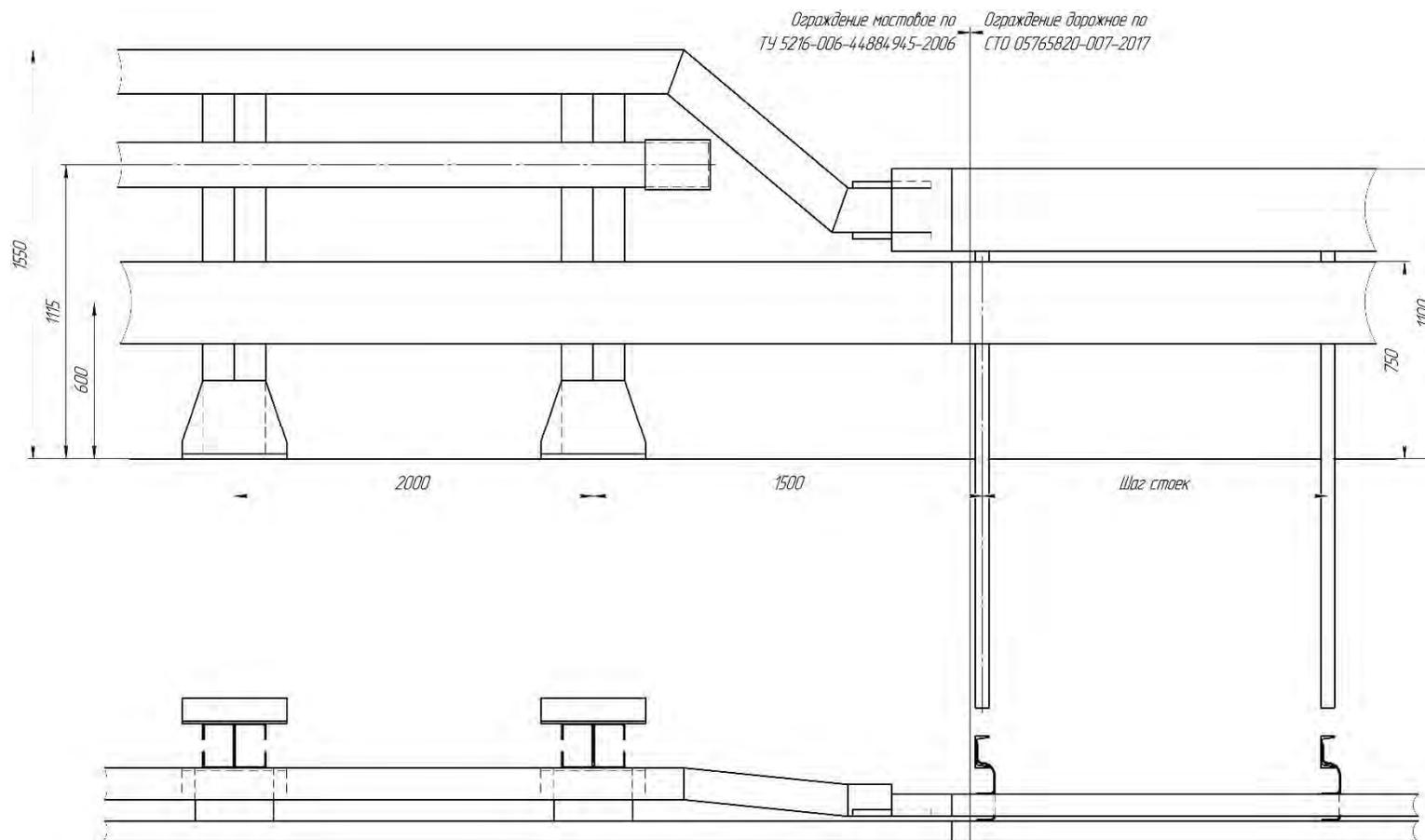
Рисунок Ж.8 – Сопряжение мостового ограждения по [15] (h-1550)
