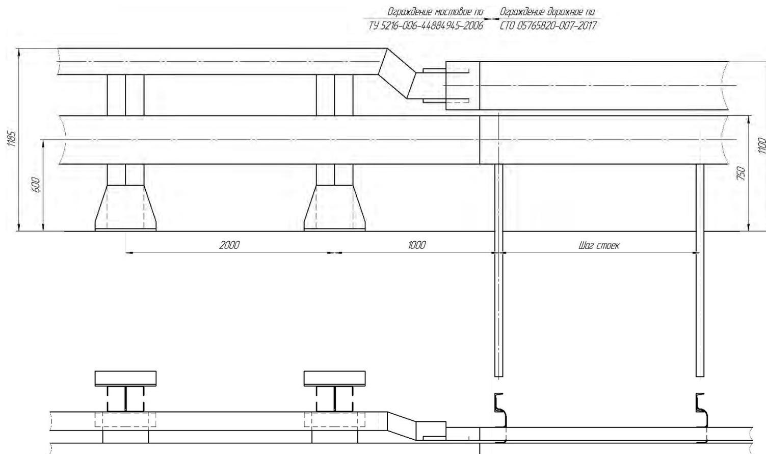
Рисунок Ж.6 – Сопряжение мостового ограждения по [15] (h-1185)
