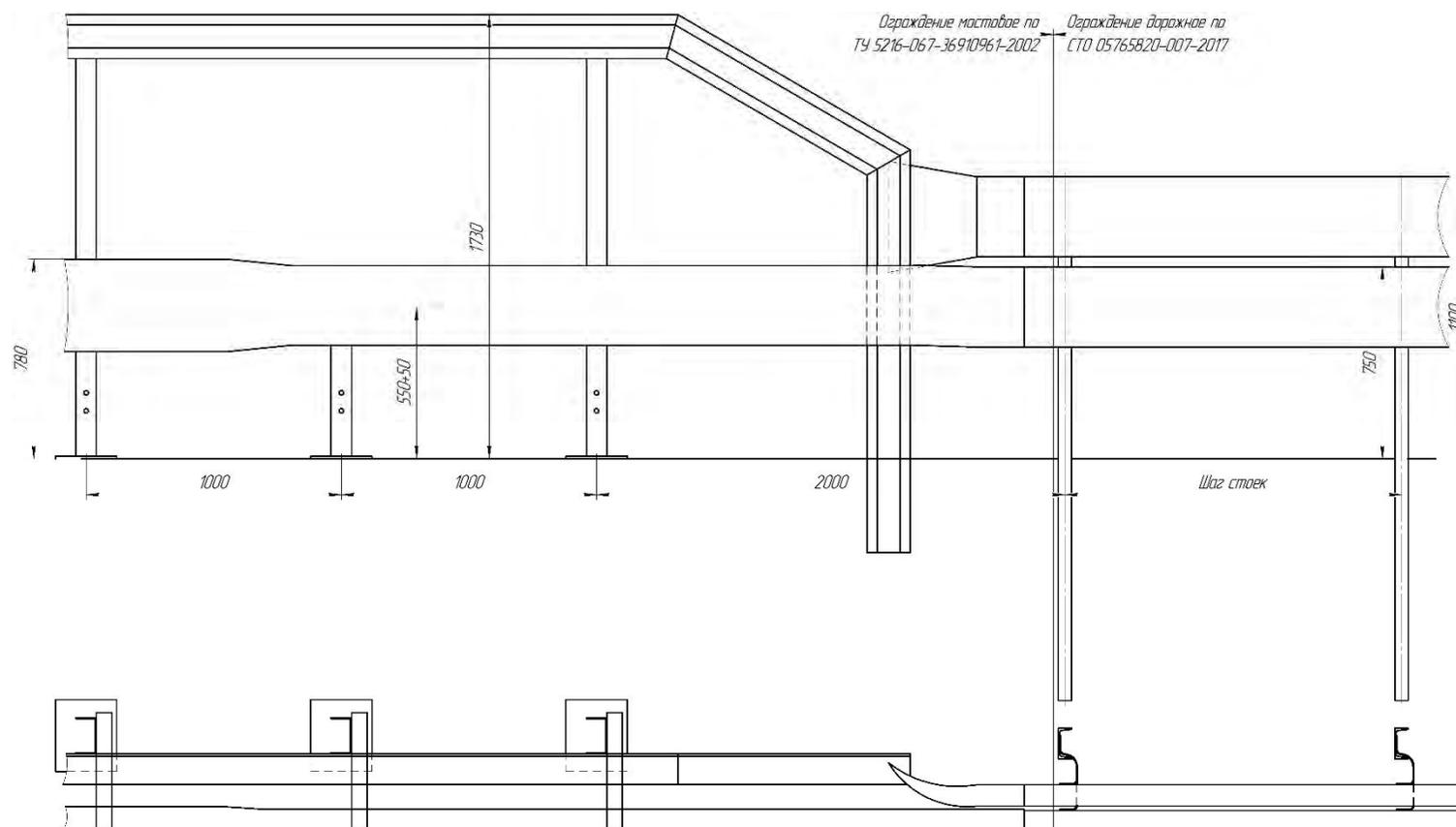
Рисунок Ж.3 – Сопряжение мостового ограждения по [8] (h-1730)
