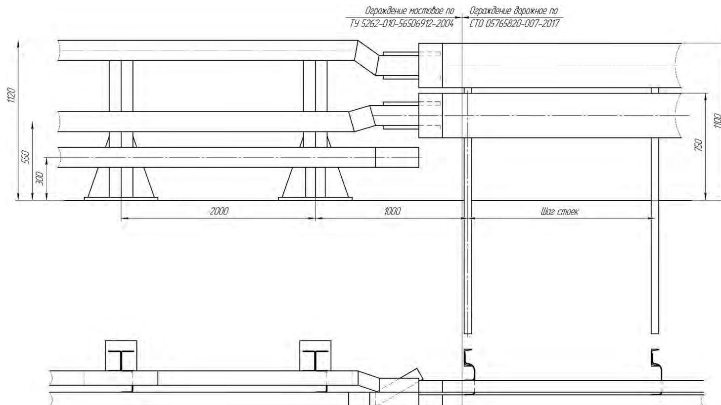
Рисунок Ж.12 – Сопряжение мостового ограждения по [12] (h-1120)
