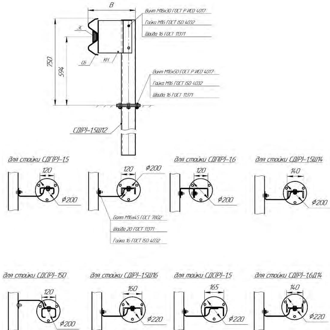
Рисунок Г.1 – Дорожное разборное ограждение 21ДО/190÷300
