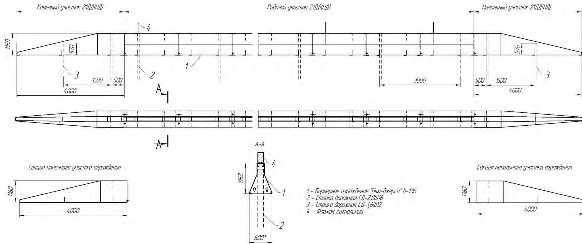
Рисунок Д.2 – Схема сборки дорожного ограждения 21ДД/350-550-1,16(НД)
