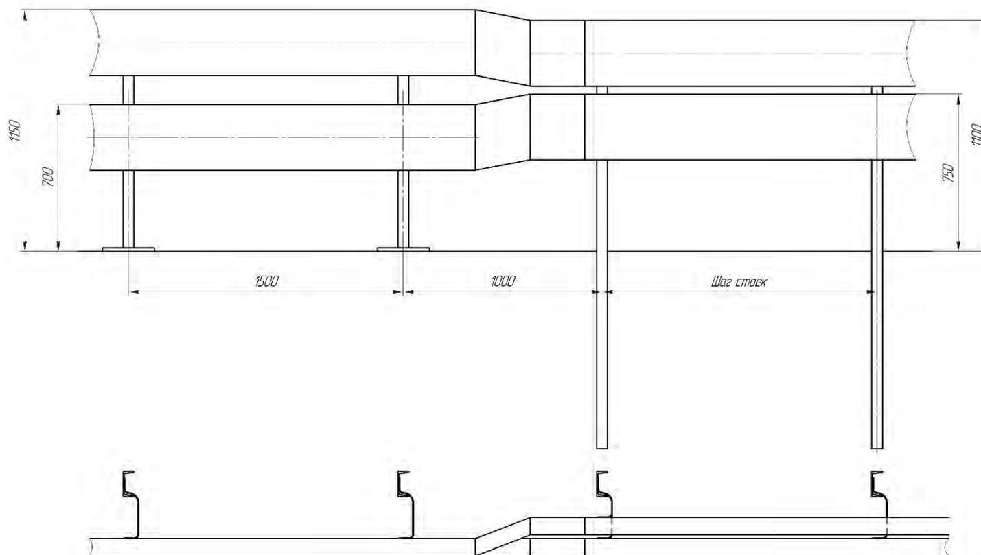
Рисунок Ж.10 – Сопряжение мостового ограждения по [11] (h-1150) с дорожным ограждением по СТО 05765820-007-2017
