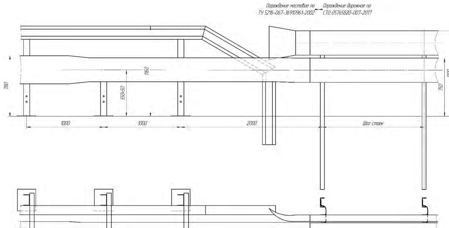
Рисунок Ж.2 – Сопряжение мостового ограждения по [8] (h-1160)
