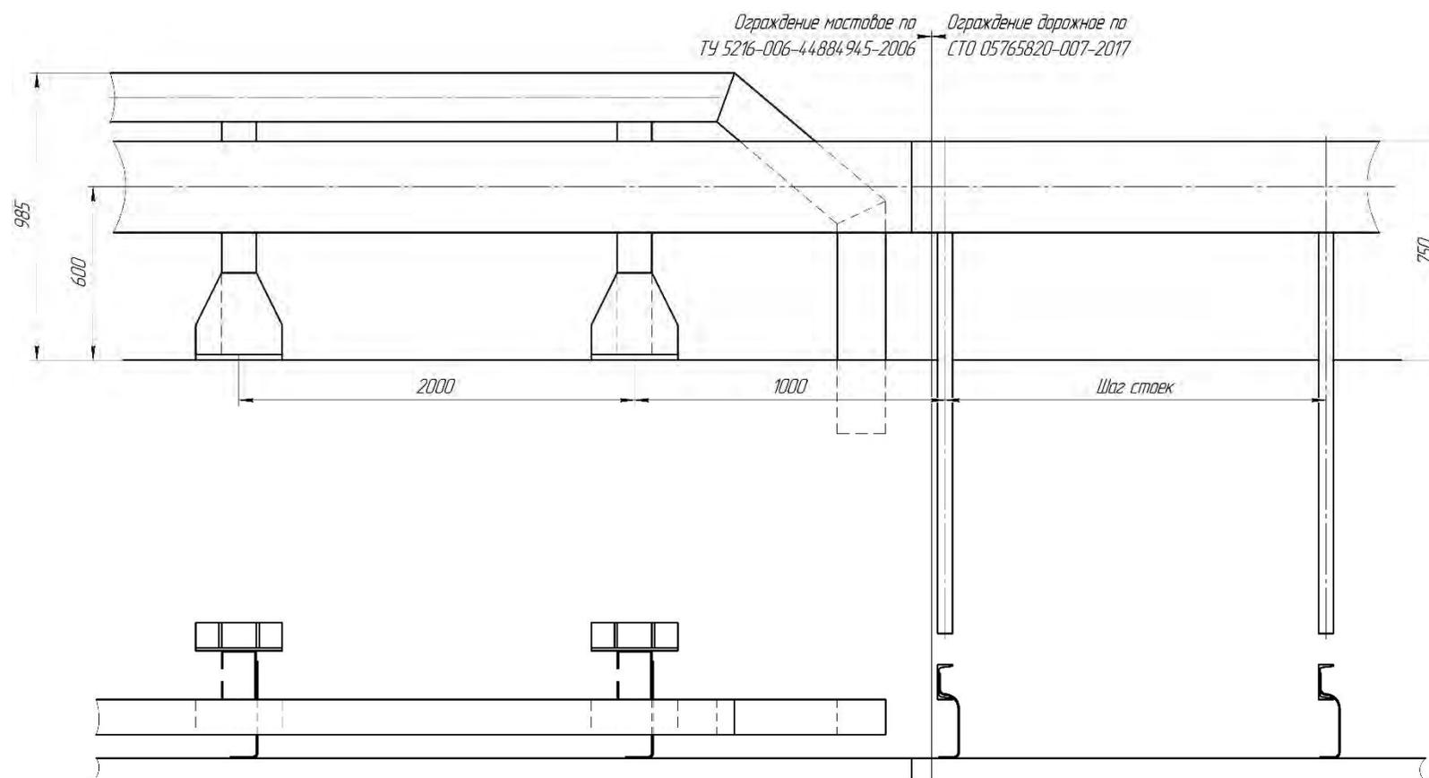
Рисунок Ж.5 – Сопряжение мостового ограждения по [15] (h-985)
