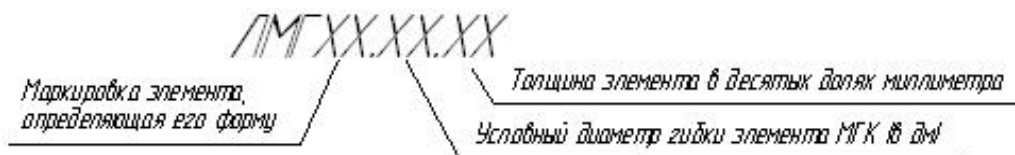
Рисунок 4.1 – Маркировка ЛМГ с параметрами гофра 130x32,5 при полезной ширине листа 910мм
