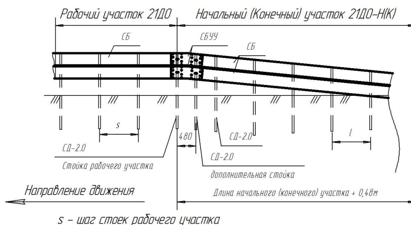
Рисунок И.3 – Схема монтажа начального (конечного) участков дорожного ограждения высотой 1,1м, с использованием СБУУ
