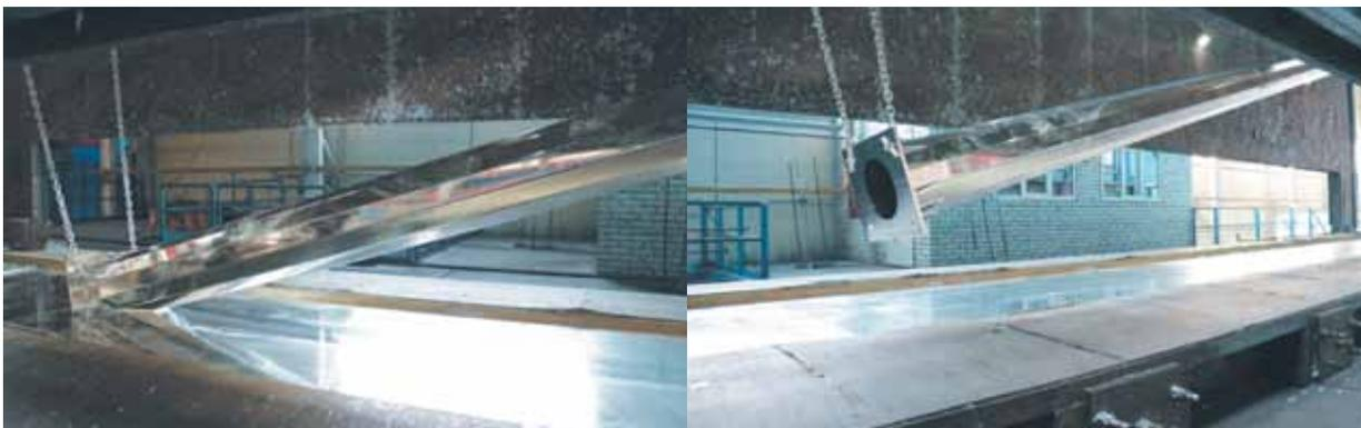
**Сварка элементов стоек** выполняется полуавтоматом в смеси защитных газов встык. Размеры и форма сварных швов соответствует ГОСТ 14771-76, качество сварных швов ГОСТ 23118-99 и п.2.4. ТУ
